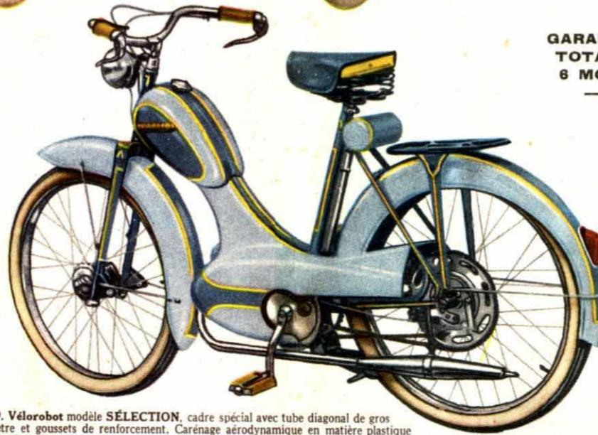
N° 59. Vélorobot modèle SÉLECTION, cadre spécial avec tube diagonal de gros diamètre et goussets de renforcement. Carénage aérodynamique en matière plastique teintée dans la masse, léger, indéformable et insonore. Fourche avant à suspension par balancier. Moyeux gros corps en métal léger ondulé, avec freins tambour incorporés. Pneus bicolores renforcés. Réservoir 5 litres. Selle grand confort avec bande lumineuse. Émail bleu clair et bleu mode, ton sur ton, avec filets or.
