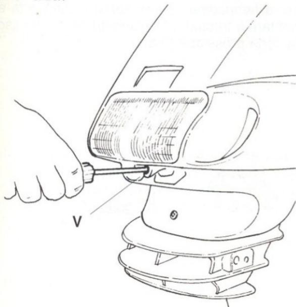
Fig. 4 (regolazione fascio luminoso)
