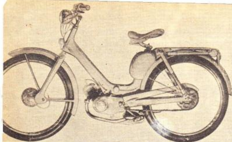
Lambretta a fait sensation en présentant un cyclomoteur. Bloc-moteur deux temps, deux vitesses. Vitesse : 50 kmh. Poids : 35 kgs.
