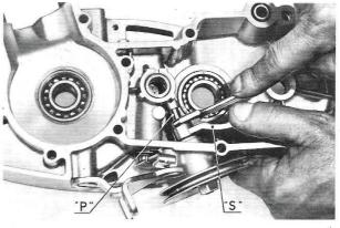
Fit the selector «S», the pin «P» and tighten the nut inside the crankcase.
