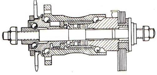
SECTION THROUGH BACK PEDALLING BRAKE HUB
