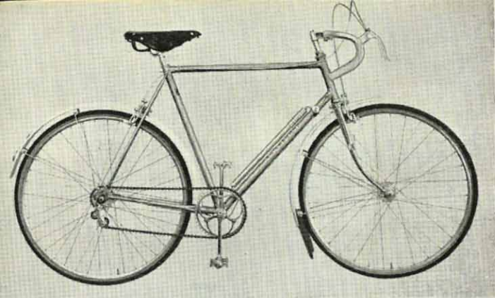
The Continental with derailleur gearing
