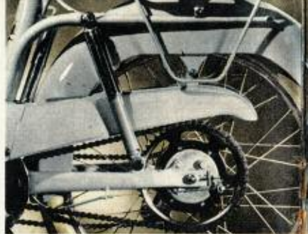
Vue de détail de la fourche oscillante à balancier.
