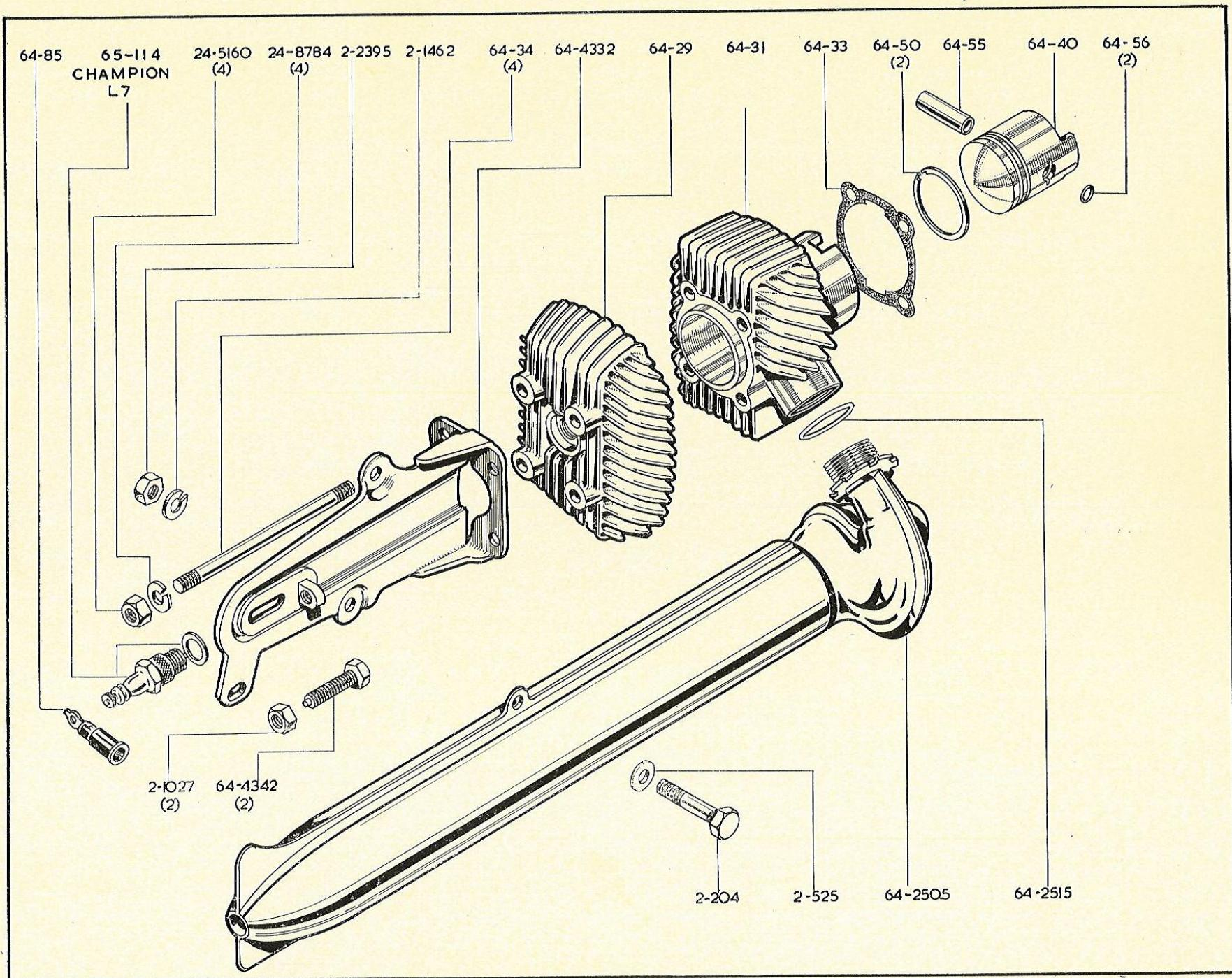
**CYLINDER, CYLINDER HEAD, SILENCER. CYLINDRE, CULASSE, SILENCIEUX
